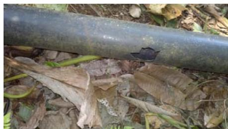
Como resultado de las lluvias se realizaron roturas en las tuberías producto de la caída piedras, ramas, troncos, y por la alta presión de la caída de agua, al no abrirse oportunamente las válvulas de rompe presión del sistema de distribución de agua.
